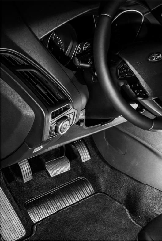
Abb. 3: Elektronisches Linksgas – Draufsicht von oben in den Fußraum
