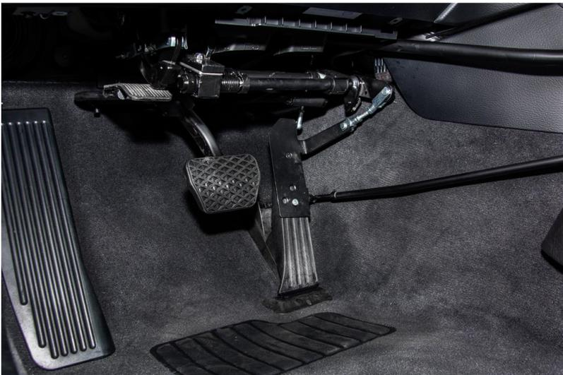
Abb. 5: Mechanisches Linksgas in einem BMW X1 mit Fußgassperre, deaktiviert = Gaspedal und Fußgassperre hochgeklappt
