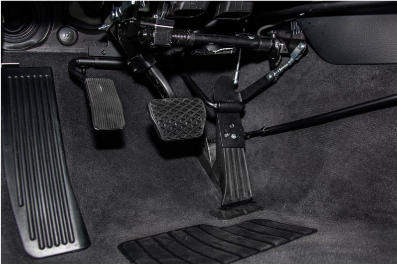
Abb. 4: Mechanisches Linksgas in einem BMW X1 mit Fußgassperre, aktiviert = Gaspedal und Fußgassperre heruntergeklappt
