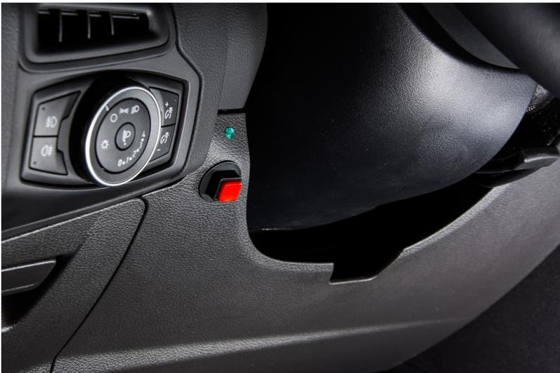
Abb. 2: Elektronisches Linksgas – Beispiel eines Umschaltknopfs am Armaturenbrett
